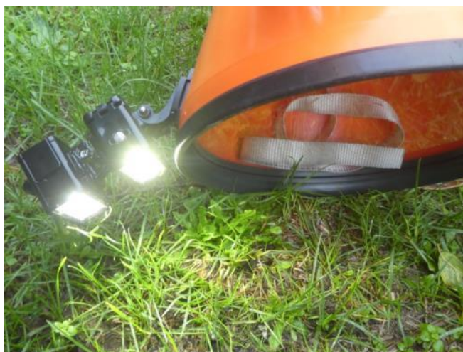
Figure 6 : exemple de bathyscope éclairé du commerce à gauche (fortement déconseillé), et d'un système d'éclairage « maison » efficient (projecteurs étanches de plongée - 2 x 300 Lumens)
