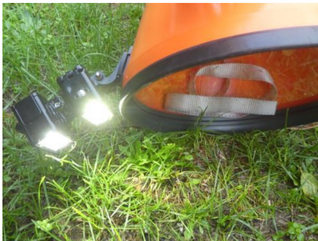
Figure 27 : exemple de bathyscope éclairé du commerce à gauche (fortement déconseillé), et d'un système d'éclairage « maison » efficient (projecteurs étanches de plongée - 2 x 300 Lumens)
