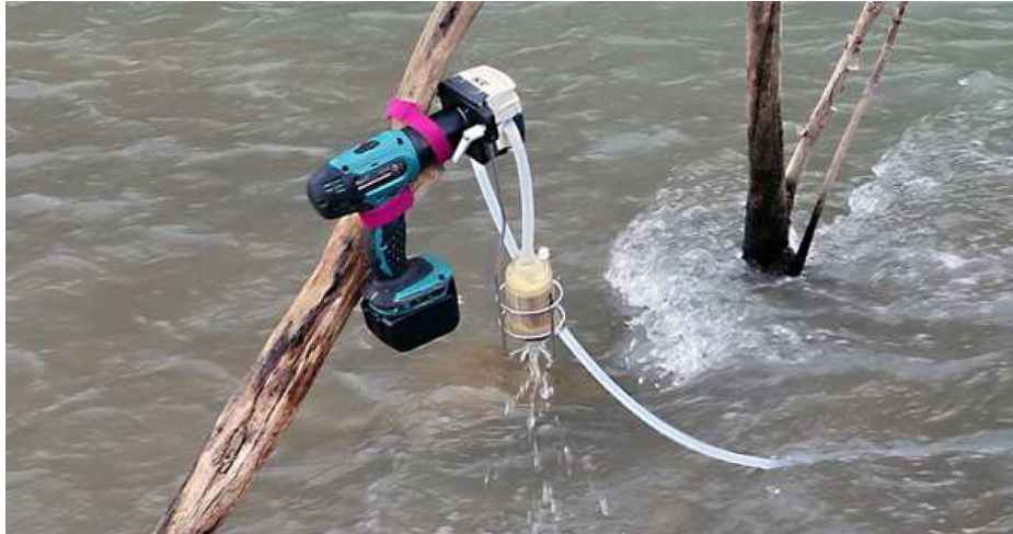
Figure 31 : exemple d'échantillonnage d'ADNe par pompage dans le cours d'eau et filtration à l'aide de la capsule dédiée (© V. Prié- Caracol)
