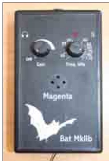
Figure n° 11 : photographie de l'appareil permettant l'inventaire des chiroptères par echolocation
